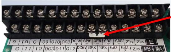
ショートバー（短絡バー）                                            | 外部にブザー電源スイッチが無い場合、ショートバー（短絡バー）で（BPS+、BPS-）間をショートさせてください。 |
